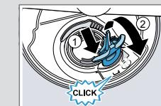
8. Montați sistemul de filtre.
