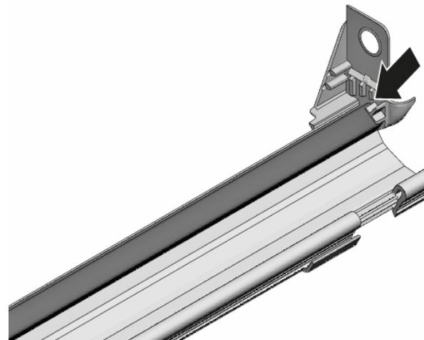
2. Introduceți garnitura ușii cu clapeta de etanșare în ușa interioară.
